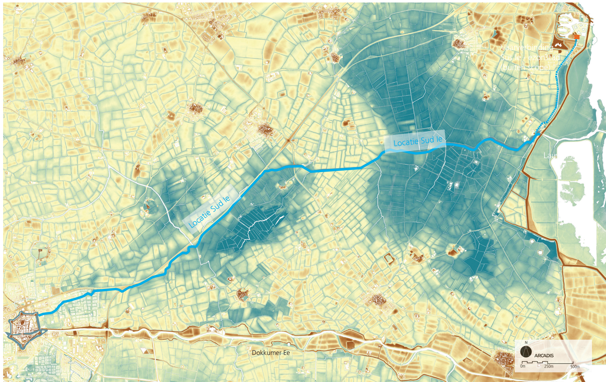
Actueel Hoogtebestand Nederland (AHN): de natuurgebieden Jouswierpolder en Anjumer Kolken zijn herkenbaar als laaggelegen gebieden als gevolg van de zoutwinning
