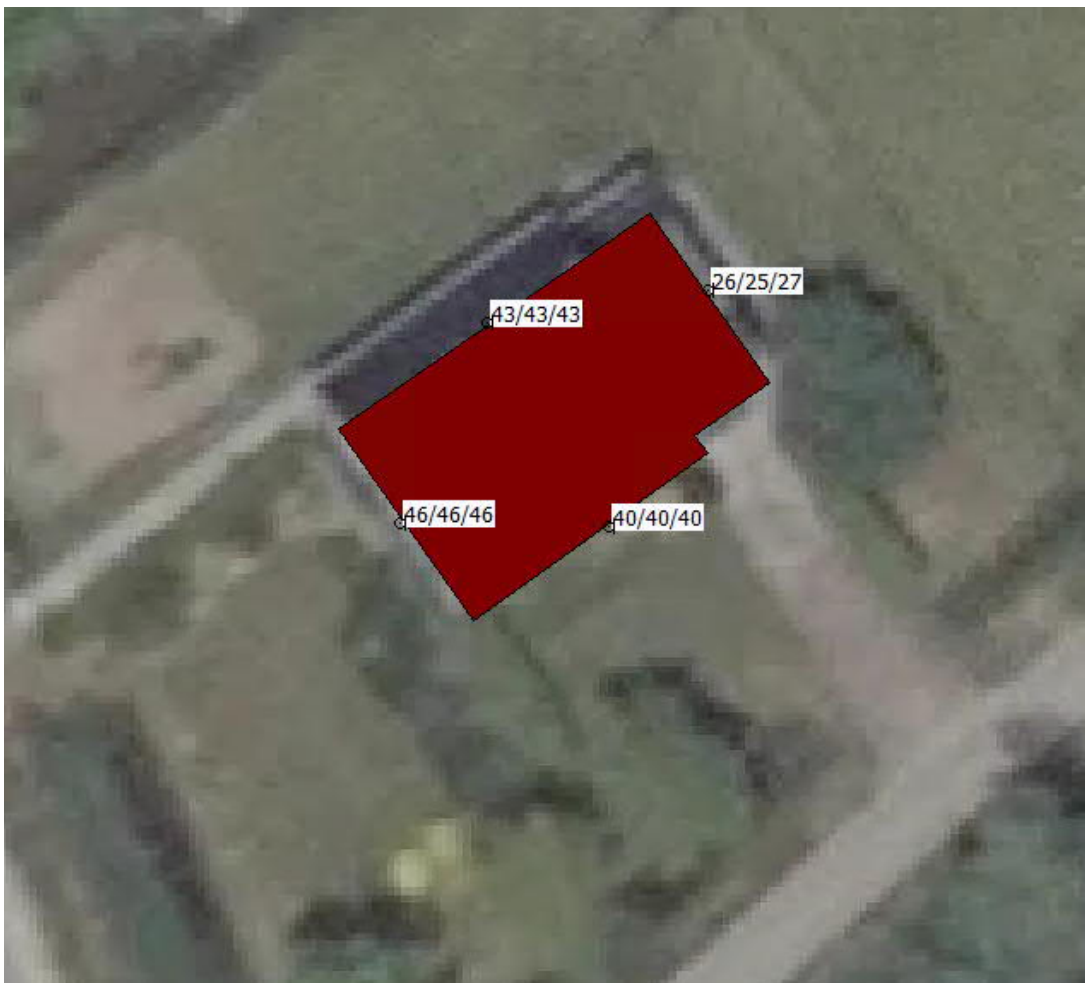
Figuur 4-3 Geluidbelasting vanwege de Moarsterwei op de woning Skiligewei 21. Geluidbelasting is inclusief correctie artikel 3.4 RMG 2012.
