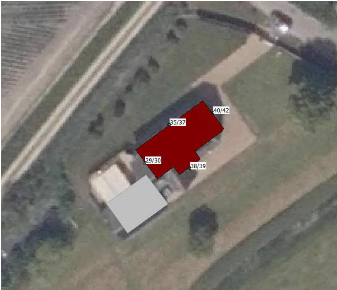
Figuur 4-2 Geluidbelasting vanwege de Moarsterwei op de woning Moarsterwei 19. Geluidbelasting is inclusief correctie artikel 3.4 RMG 2012.
