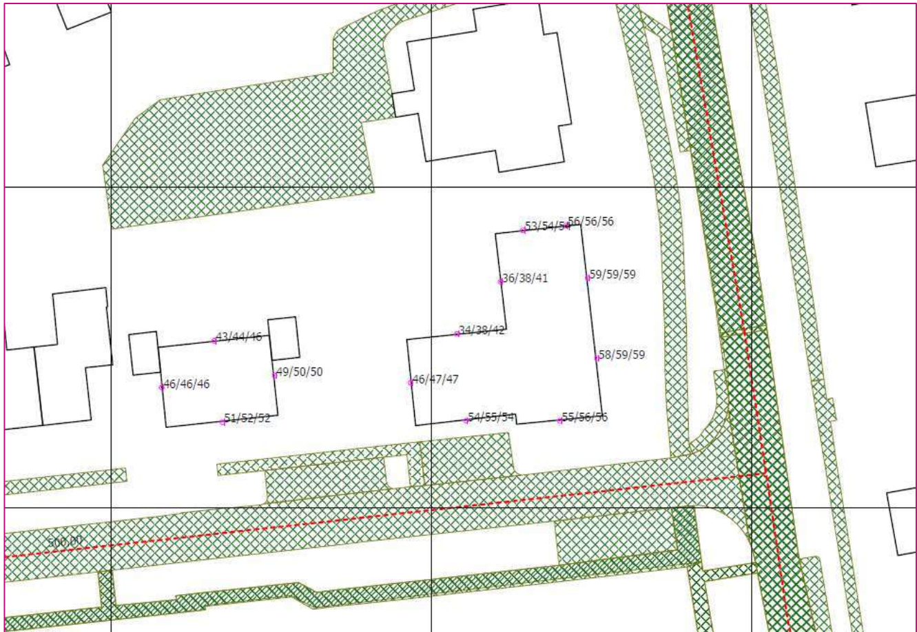
Figuur 6: overzicht van de berekende geluidbelasting vanwege L_{den} in dB vanwege de gehele Hantumerweg, exclusief 5 dB aftrek op basis van artikel 110g Wgh (30 km-gedeelte Hantumerweg en Learmûne en 50 km-gedeelte Hantumerweg)
