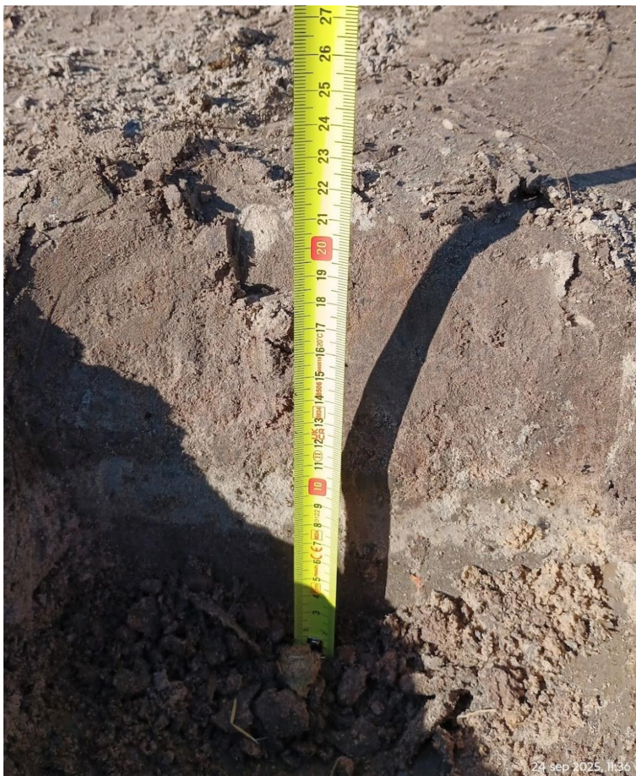
Gat 1. De kleilaag is ongeveer 6 centimeter, de zandlaag is ongeveer 3 centimeter dik en de bovenste laag van gemengde grond is ongeveer 10 centimeter dik.
