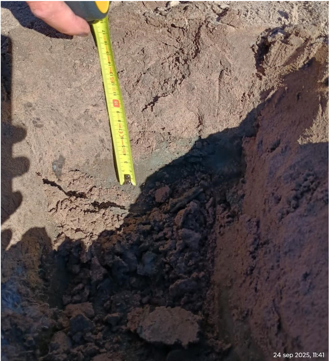
Gat 2. Het gat is ongeveer 17 centimeter diep. De eerste 6 centimeter is de harde klei. De volgende 11 centimeter is gemengde grond van zand met een andere grondsoort.
