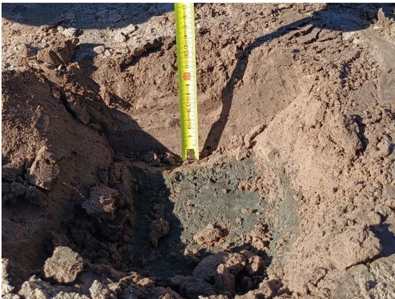
Gat 3. Op ongeveer 12 centimeter van het oppervlak ligt de harde kleilaag. De laag grond die er bovenop ligt is een gemengde laag zand met andere grond.
